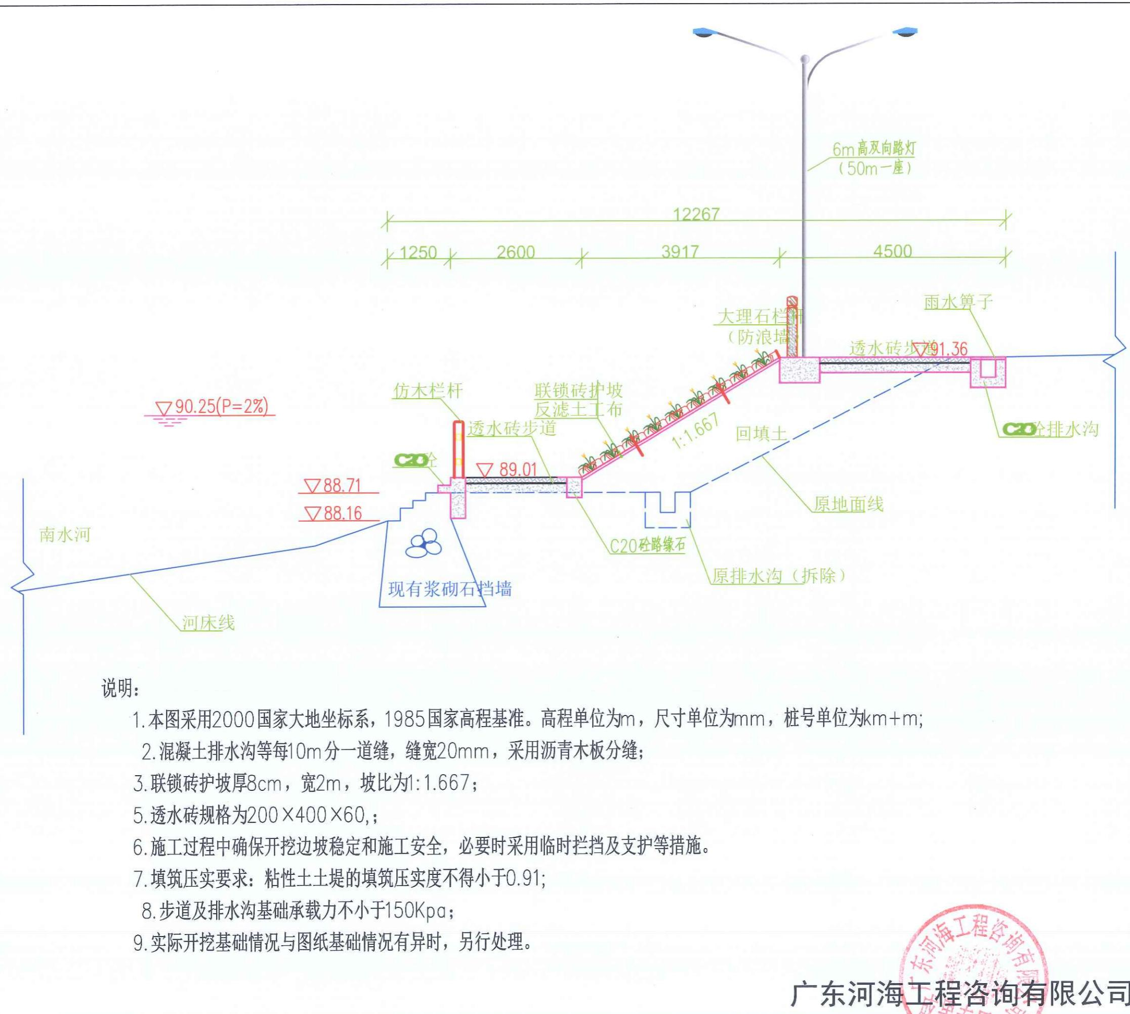
附件1.2 自来水厂至南水大桥左岸河段改造工程典型断面图
